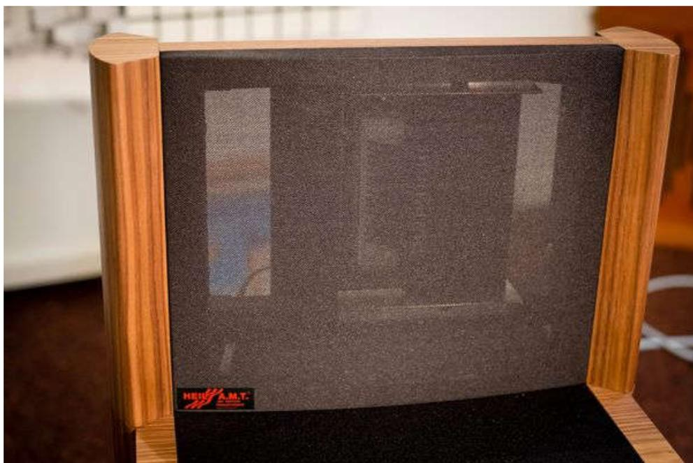
Die neuste Generation des Heil-Air-Motion-Transformers für den phasenrichtigen und äusserst homogenen Mittel-Hochtonbereich.
