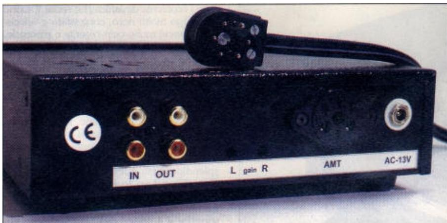
L'unità di amplificazione prevede la possibilità di essere inserita nell'anello di tape. Il connettore della cuffia non è, evidentemente, il classico spinotto, ma un'uscita standard è presente sul frontale.
