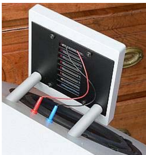
Das Heil System gehört zu den Dipolstrahlern, die ihre akustische Energie nach vorne und hinten abgeben.
