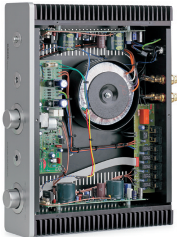
Ganz klassisch: der Aufbau des A21 SE (unten) mit den kanalgetrennten Endstufensektionen und die große Platine des Phonoverstärkers PA-4 (links).
